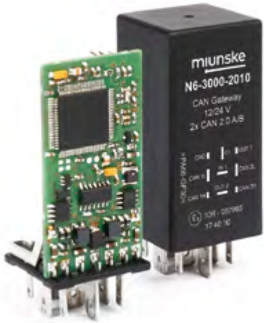
Das miunske CAN Gateway passt, wie das I/O Nano, auf alle Mini-Relaissockel von miunske
